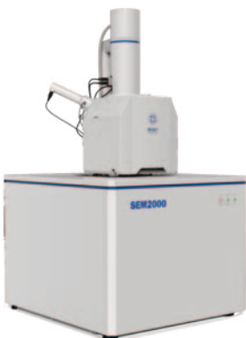
SEM2000 Tungsteno 3.9nm @ 20kV
