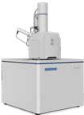
SEM2000 Tungsteno 3.9nm @ 20kV
