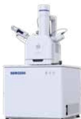
SEM3200 Tungsteno 3nm @30kV 8nm @3 kV
